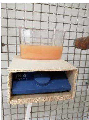
Abb. 2: Magnetrührer im Einsatz mit der Ampho M.-Lösung
